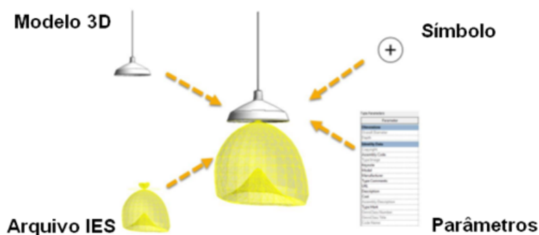
Figura 17 - Elementos componentes do objeto Luminária para uso em modelos BIM.
